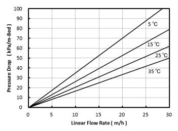
Fig. 1 Pressure Drop of UBK535K
